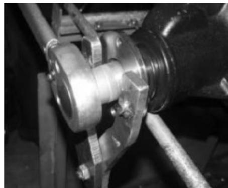
5.2、如图所示，用三爪拉马将传动法兰拔出。
