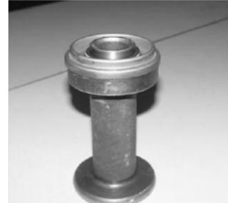
5.6、如图所示，将油封轻轻打入主减速器油封径处。
