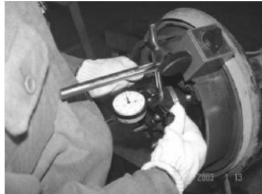
注：后桥半轴轴向间隙规范为 0.05mm-0.46mm，若发现轴向间隙超差，切记不可自行加垫片处理，以免造成轴承烧毁。
